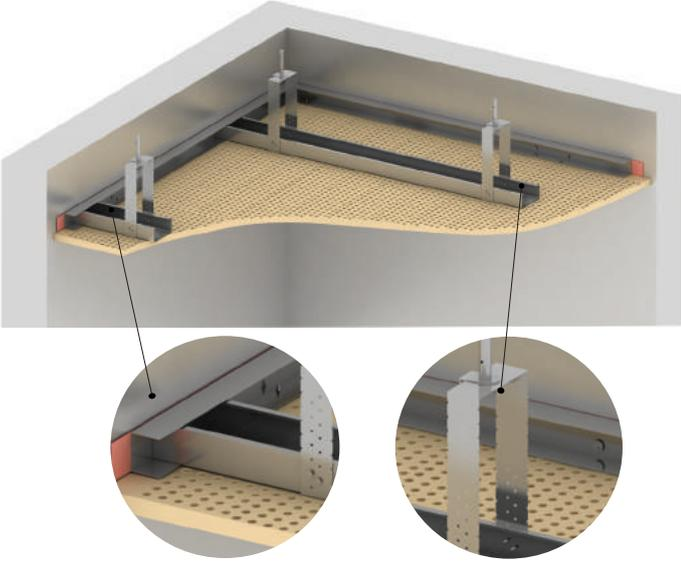
Tavan arası mesafenin en fazla 20 cm olduğu, sürekli görünüm sağlayan akustik asma tavanlarda kullanılır. Akustik alçı levhaların birleşim yerlerindeki derzler görünmeden, mekân içinde ses yutumu sağlar, çınlamayı önler.
