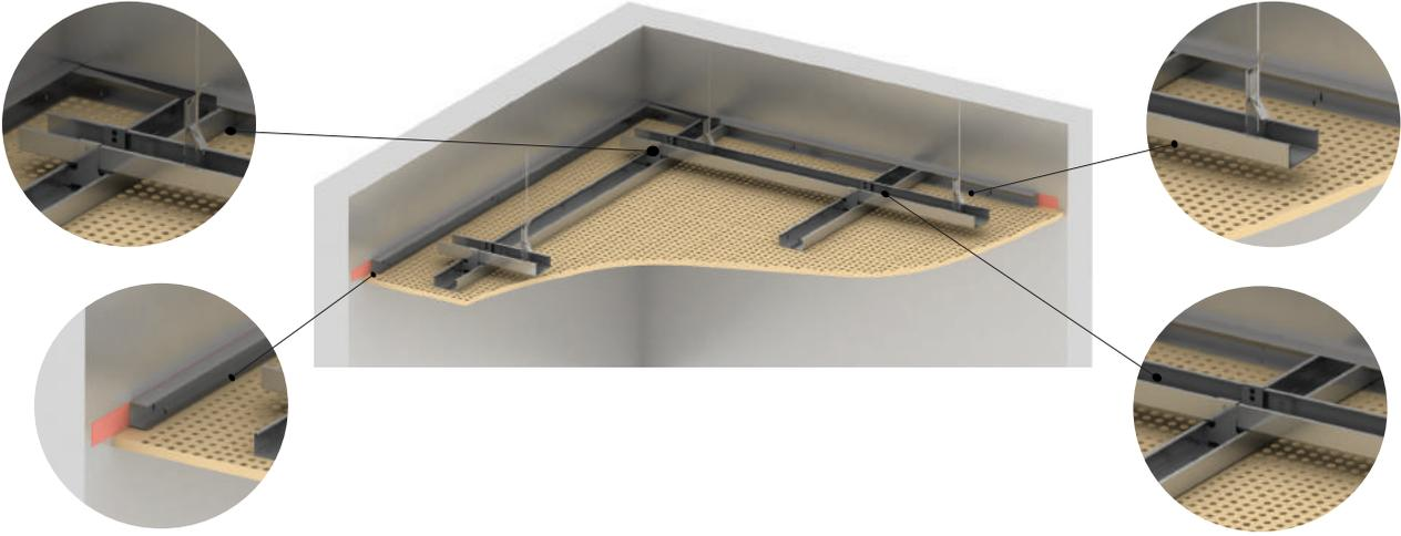
Sürekli, kesintisiz akustik asma tavanlarda kullanılır. Farklı delik modeli seçenekleri vardır. Akustik alçı levhaların birleşim yerlerindeki derzler görünmeden, mekân içinde ses yutumu sağlar, çınlamayı önler.
