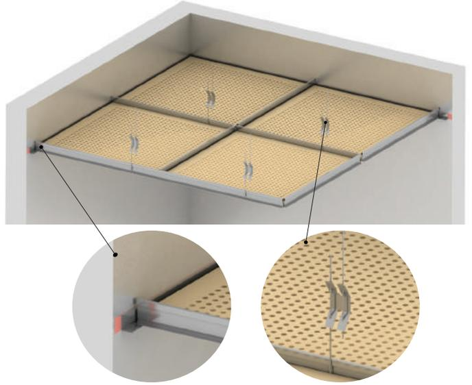
Modüler akustik asma tavanlarda kullanılır. Tekstür kaplı, boyalı akustik alçı levhalar T taşıyıcı sistemler üzerine oturtulur. Mekan içinde ses yankılanmasını engelleyerek estetik ve konforlu alanlar oluşturur.
