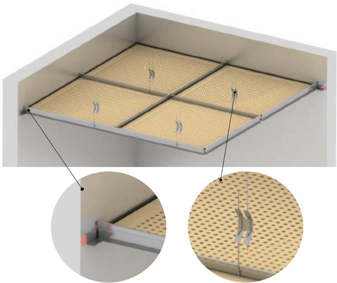
Tavan arası mesafenin en fazla 20 cm olduğu, sürekli görünüm sağlayan akustik asma tavanlarda kullanılır. Akustik alçı levhaların bireleşim yerlerindeki derzler görünmeden, mekân içinde ses yutumunu sağlar, çınlamayı öner.
